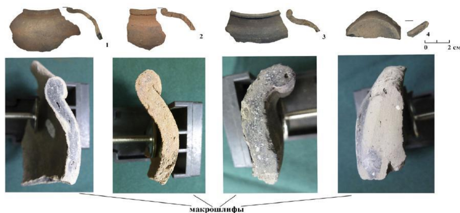
Рисунок 3. Макрошлифы керамических изделий: 1–2 – красноглиняная керамика; 3–4 – мореная керамика
